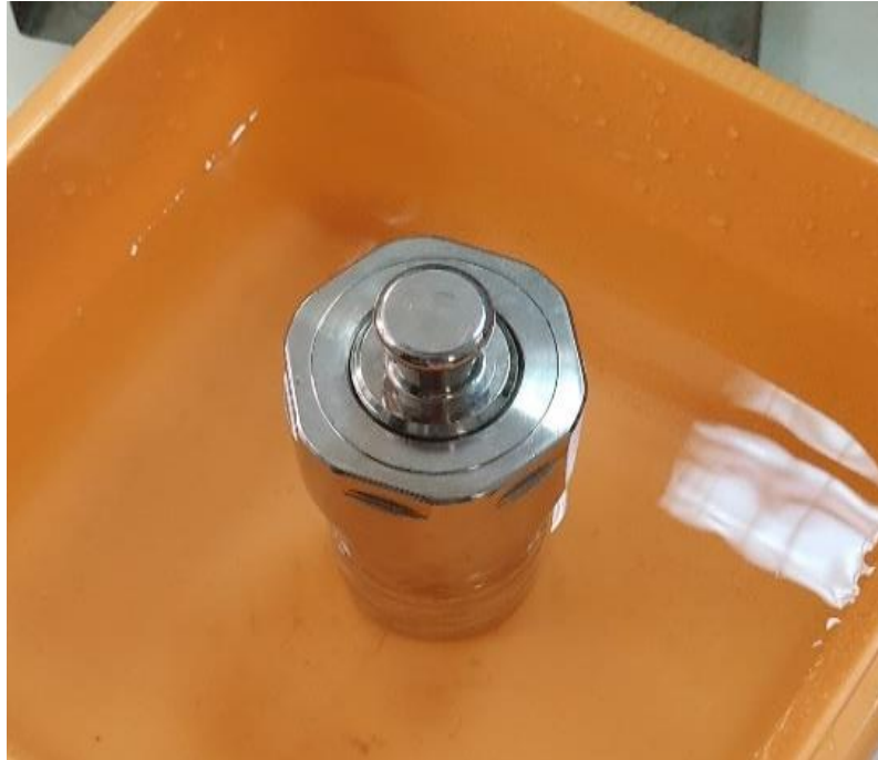
Εικόνα 41 : Τοποθέτηση υδροθερμικού αντιδραστήρα σε λεκάνη με κρύο νερό για ομαλή μείωση της θερμοκρασίας του μετά από την υδροθερμική επεξεργασία
