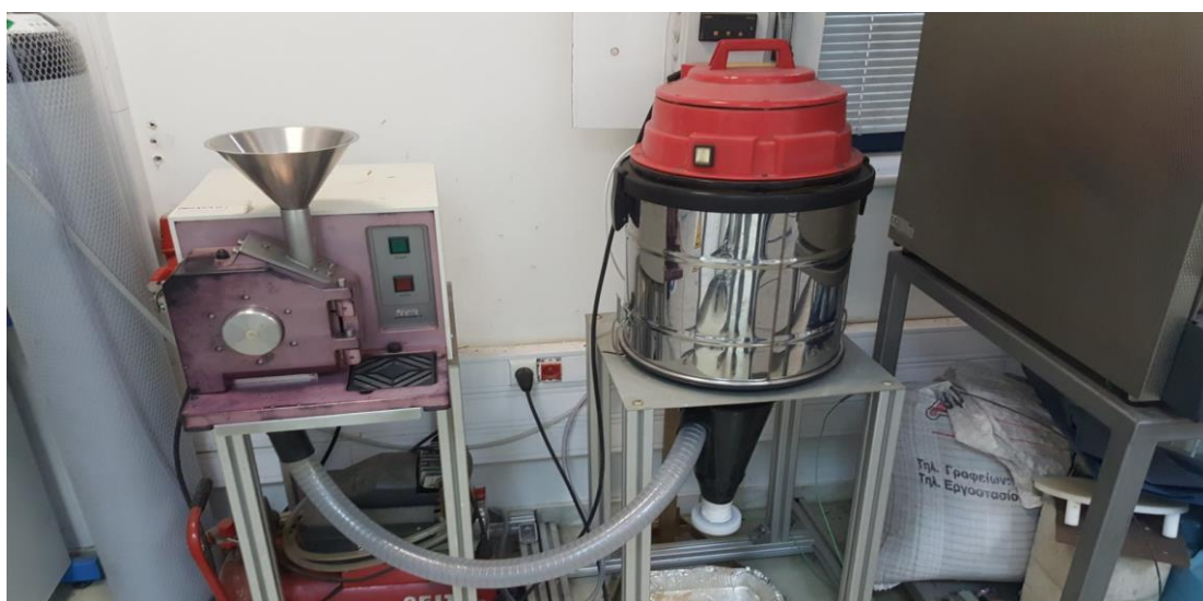
Εικόνα 38 : Εγκατάσταση συσκευής κονιορτοποίησης του εργαστηρίου επικίνδυνων και τοξικών αποβλήτων πολυτεχνείου Κρήτης
