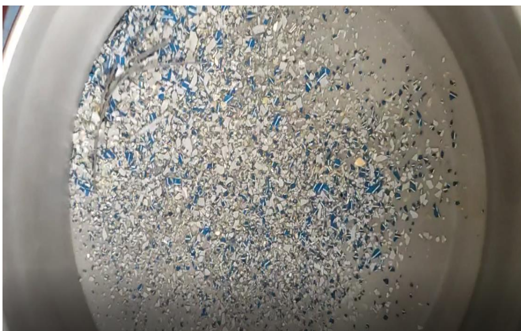
Εικόνα 36 : Κοσκίνισμα του στερεού δείγματος
