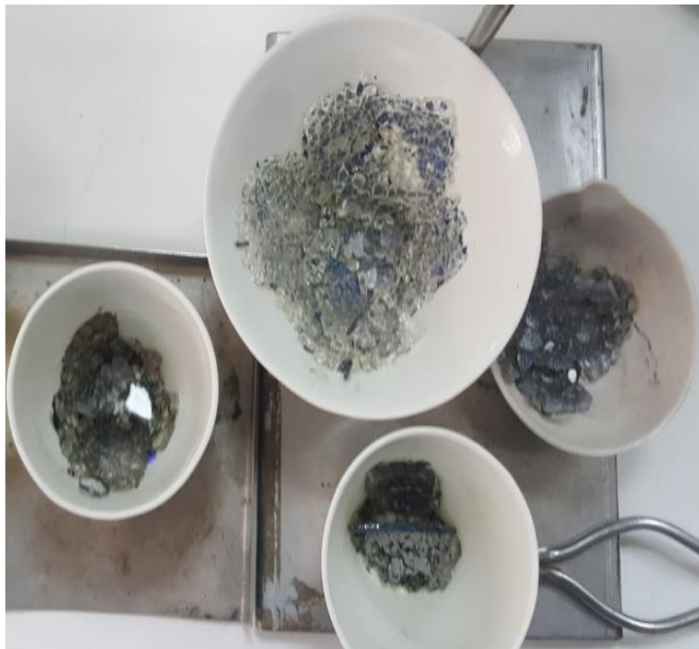
Εικόνα 32 : Δείγματα μετά την αποτέφρωση και αποκόλληση των υλικών
