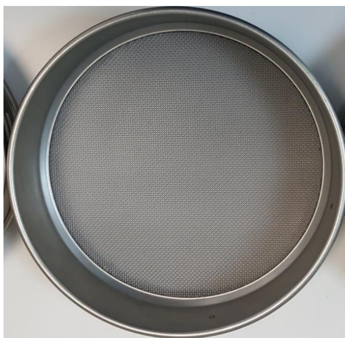
Εικόνα 35 : Κόσκινο διαμέτρου (1mm)
