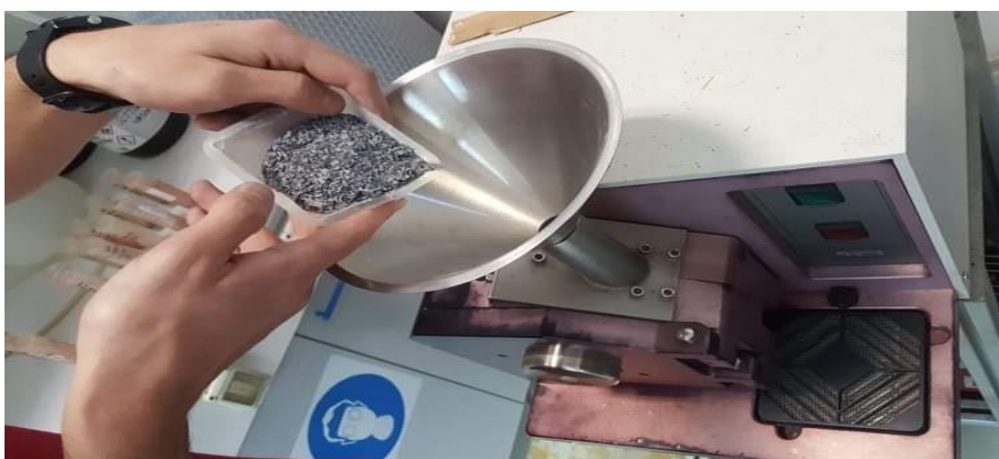
Εικόνα 39 : Τοποθέτηση του δείγματος για κονιορτοποίηση
