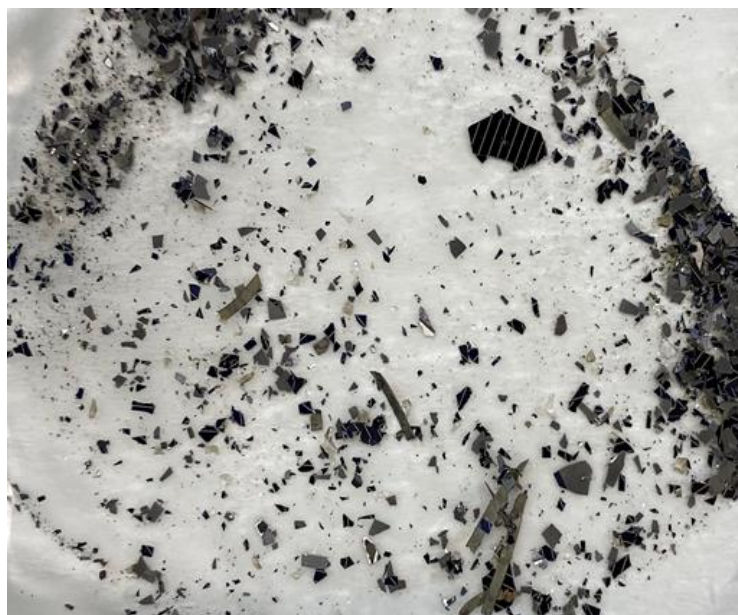
Εικόνα 47 : Δείγμα μονοκρυσταλλικού κελιού μετά από διήθηση
