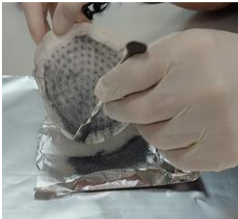
Εικόνα 48 : Δείγμα μονοκρυσταλλικού κελιού μετά ξήρανση
