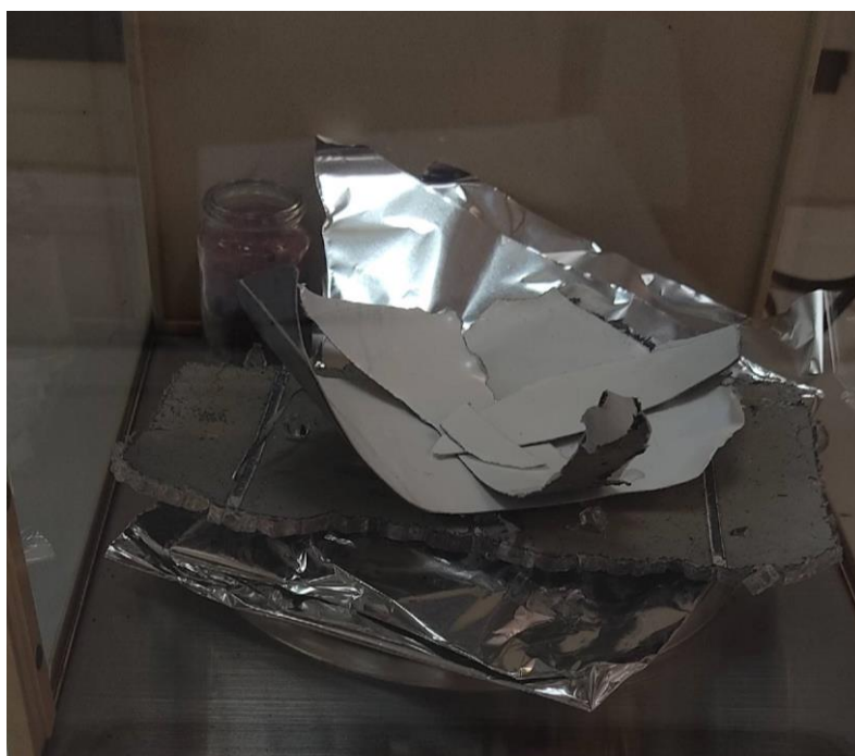
Εικόνα 29 : Αφαίρεση λευκής επιφάνειας του φωτοβολταϊκού η οποία περιέχει την χημική ένωση Tedlar (πολυβινυλοφθορίδιο)
