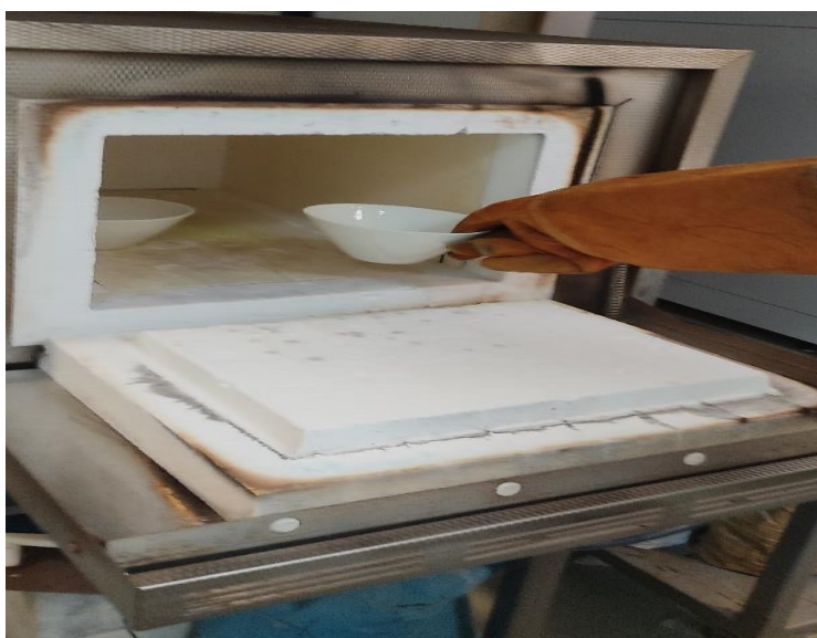
Εικόνα 31 : Τοποθέτηση δειγμάτων σε κλίβανο
