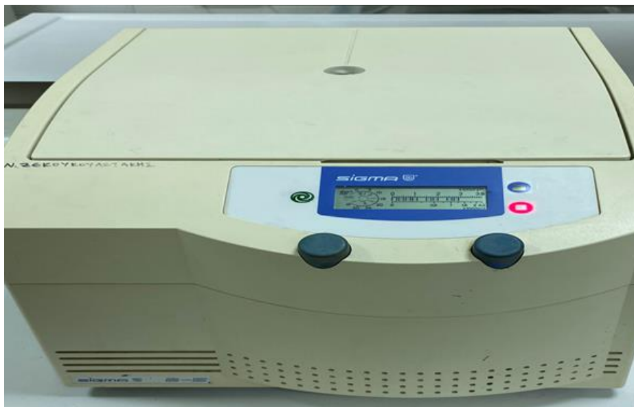
Εικόνα 43 : Εργαστηριακό όργανο για φυγοκέντρωση των δειγμάτων
